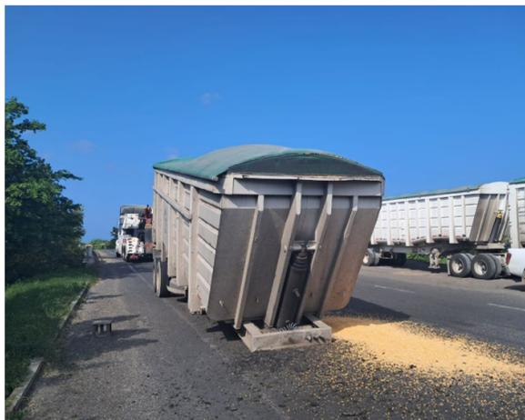
repentina, el segundo remolque se desenganchó del sistema de acoplamiento "Dolly", quedando atravesado sobre la carpeta asfáltica.
