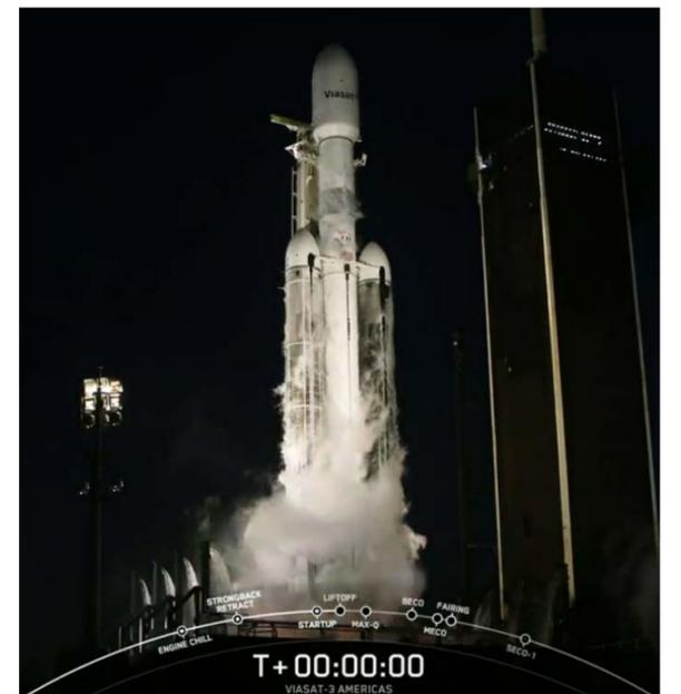
Falcon 9 que forman un compacto propulsor que se eleva impulsado por 27 motores Merlin y con la potencia de 18 aviones comerciales.
